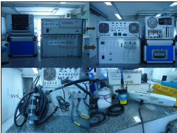
Figura 3 - Equipamento do sistema multifeixe; Parte superior: Unidade Transceptora, Processadora e CPU; Parte Inferior: Sensor de velocidade do som (SVS), antena GPS, Compensador de movimento da embarcação e a bússola digital Giro.
